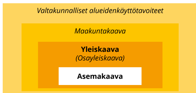
Kuva 3. Suomen maankäyttöjärjestelmä visualisoituna kaaviona. Kaavoituksen eri tasot muodostavat yhdessä kokonaisuuden, jossa ylempien tasojen kaavat ohjaavat alempien tasojen kaavoitusta.
