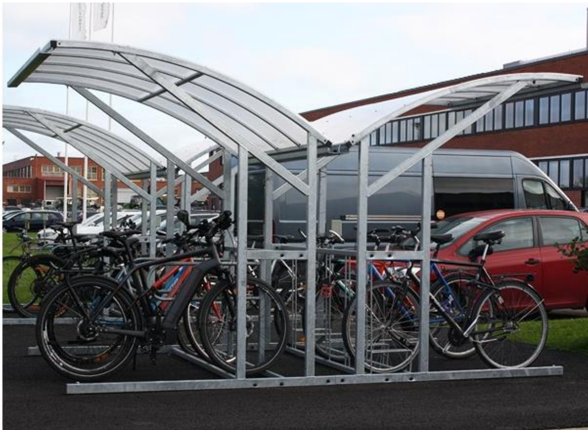
Kuva 16 Esimerkki runkolukittavasta katoksellisesta pyöräpysäköintipaikasta, kuva: Finture Oy
