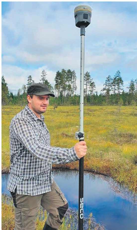
Tapio Oy:n Jani Antila käyttää maastokartoituksissa tarkkaan satelliittipaikannukseen kykenevää GNSS-laitetta.
